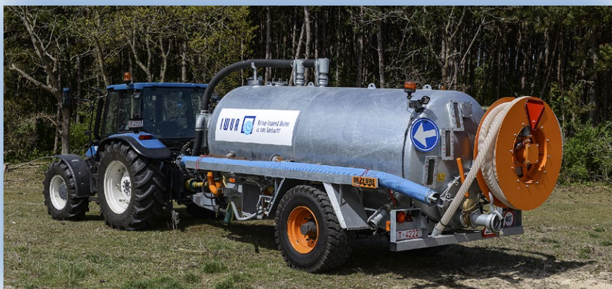
In 2014 werd de FAUN-spoelwagen die gebruikt werd bij het spoelen van de filterputten, vervangen door een nieuw voertuig. De nieuwe spoelkar beschikt nu ook over een vacuÛmpomp.
