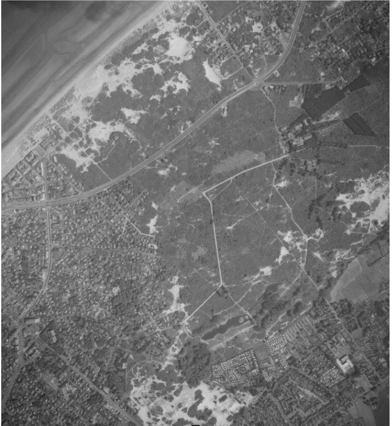
Fig. 1.11. Luchtfoto 2004 (S2-A 998). In het zuiden van het projectgebied zijn de infiltratiepanden van het huidige Aquaduin zichtbaar. Ze worden gebruikt voor een kunstmatige aanvulling van grondwater en de daaropvolgende winning van het infiltratiewater in de waterwinning van St. André. Het grootste deel van het duinengebied is ondertussen verstruweeld of met bos bezet. Alleen in de Schipgatduinen, rond de Hoge Blekker en in het zuidoosten van de Doornpanne (ANB eigendom) is nog een aanzienlijke oppervlakte duin niet of slechts schaars begroeid.
